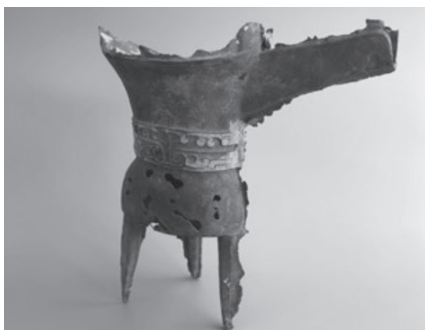
图 7 带有气孔等铸造缺陷的铜爵（笔者提供）
