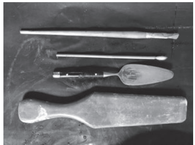
图3 陶范制备时的工具：刮刀、毛笔、条状木锤（筆者提供）
