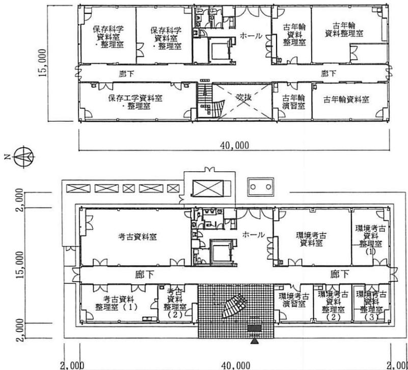
文化財資料棟 一階平面図（600m<sup>2</sup> 下） 二階平面図（566.91m<sup>2</sup> 上）
