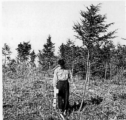
探査風景 (FM18型グラジオメーター使用)
