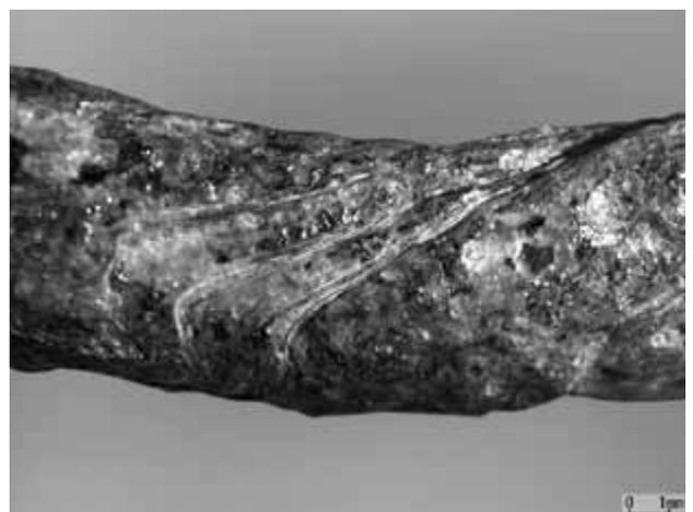
図49 試料No. 2ガラスの接合部分と見られる部分
