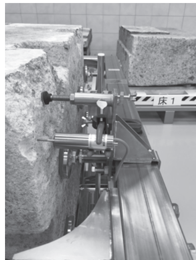
高松塚石室石材の振動に対する安定性調査。センサー設置状況。
