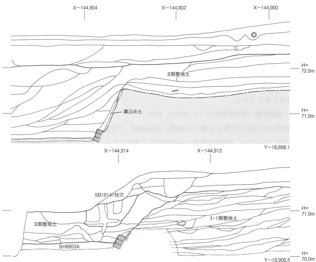
図 22 磚積擁壁 SX6600 断面図 1:50
