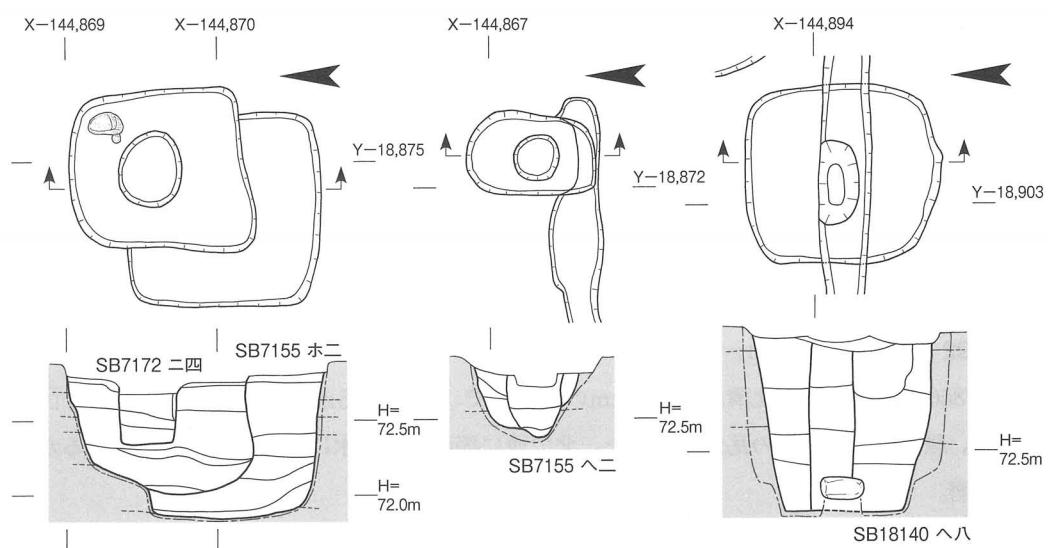
図39 SB7155・SB7172・SB18140 柱穴 1:50
