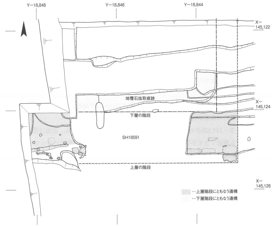
図 25 南門 SB7801 南面階段地覆抜取痕跡 1:50
