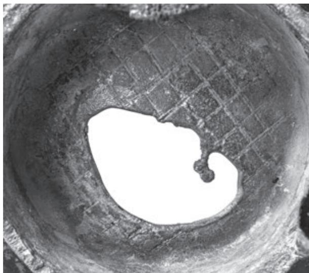
图2 第1回実験の製品1 凹線となった底部人工刻線
