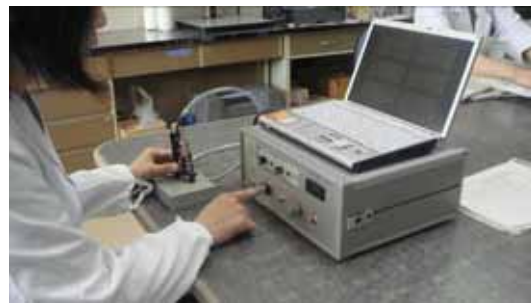
図5 石造文化財用打音試験装置
