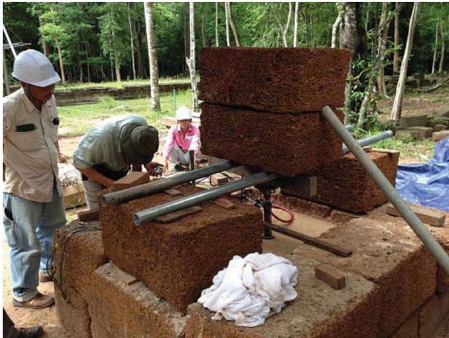
試験盛土による支持力と耐侵食性の確認 Confirmation of bearing capacity and erosion resistance of test soils
