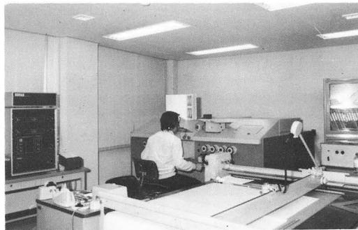
写真測量図化機 ステレオメトログラフE型を
