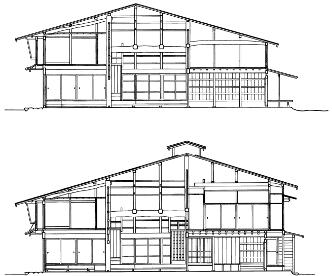
図68 徳利屋原家住宅主屋断面図 (上が明治頃、下が現状)
