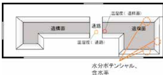
図23 土壌水分状態測定箇所（南棟）
