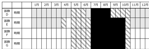
図10 壁面に非接触な装飾の濡れの推移 (目視観察)
