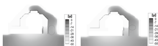
図49 CASE D-1の8月の水分化学ポテンシャル分布 図50 CASE D-4の8月の水分化学ポテンシャル分布 [J/kg]
