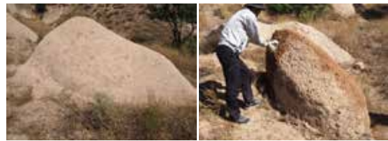
図8：屋外暴露試験体（左）無処置（右）表面処理
