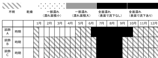
図9 北側壁面に接触する装飾の濡れの推移 (目視観察)
