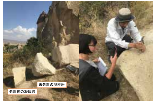
図12：パシャバー地区での小岩体試験体(左)と風化度合いの測定の指導(右)
