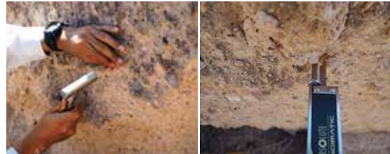
図9：風化の度合いの定量化 （左）ステンレス釘の打ち込み（右）釘の出しの長さ測定
