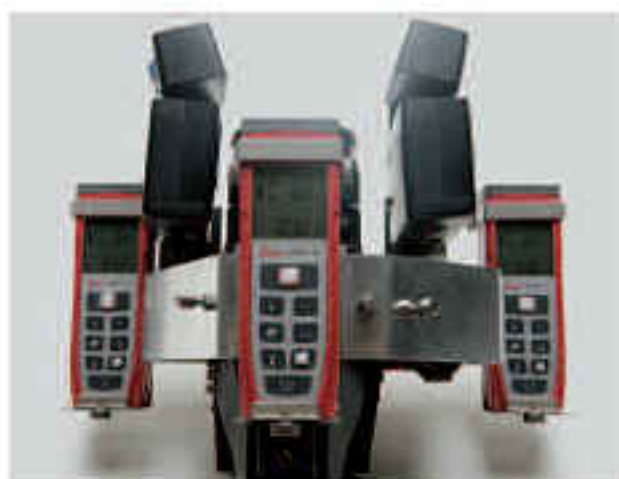
Fig. 24 三台の測距機の数字を合わせる
