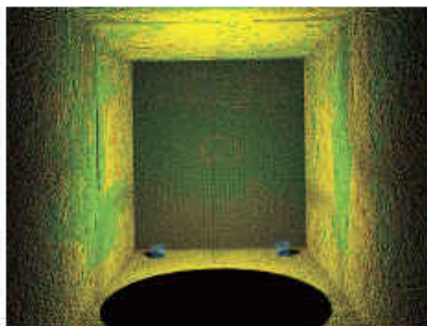
Fig.8 3D計測による点群データの傾度表示
