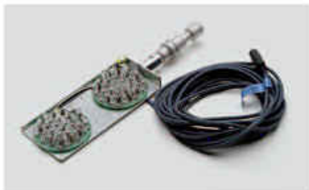
Fig. 22 LED照明装置
