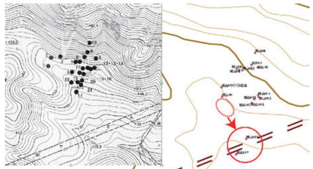
図9 東六甲採石場城山刻印群H地区 2006年の調査による位置(左)と2022年の調査による位置(右)。再計測の結果、17番石材が南へ約80m移動。(『徳川大坂城東六甲採石場』兵庫県教育委員会事務局文化財室、2008年)
